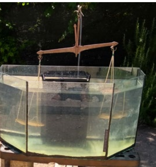
Figura 106. Balança que exhibe sua descoberta de que a massa de uma substância é vinculada ao volume, no caso, alterando o volume original da água.
