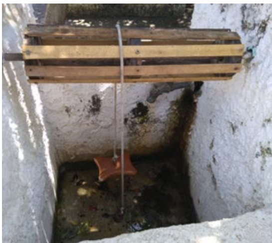
Figuras 108 e 109. O relógio de água (clepsidra) de Arquimedes. O ponteiro de horas, ligado ao eixo à direita de madeira, é movido pelo lento esvaziar, ou encher do tanque.
