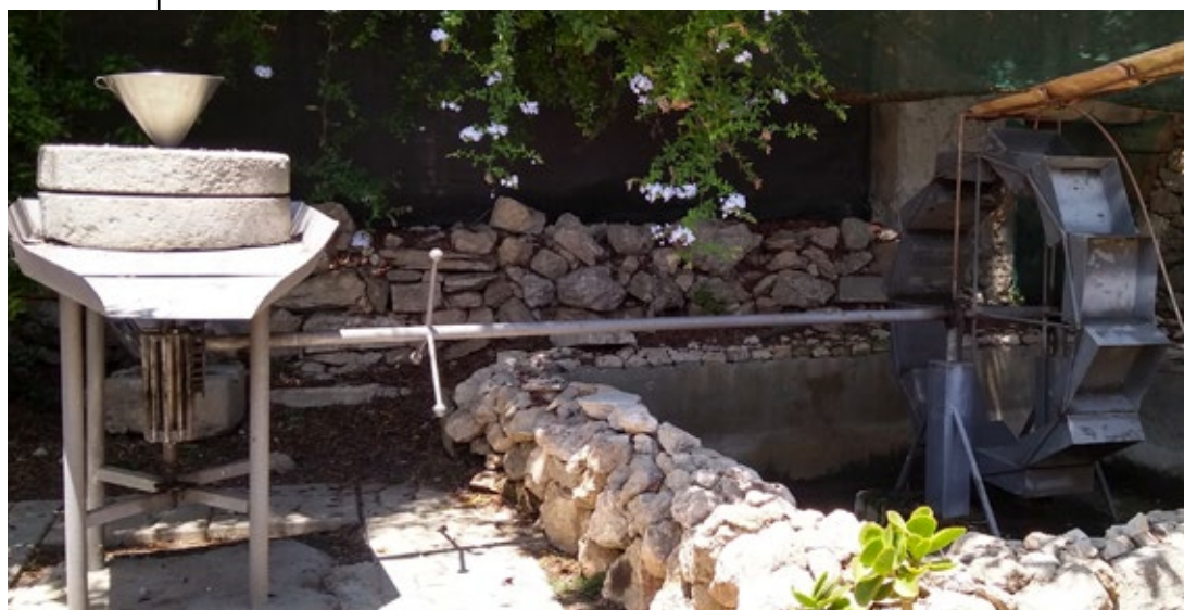
Figura 105 (abaixo). Sistema de moinho criado por Arquimedes, utilizando a queda d'água, que ao movimentar a roda d'água, gira um eixo, que ligado a engrenagens, faz girar uma pedra sobre a outra, moendo grãos.
