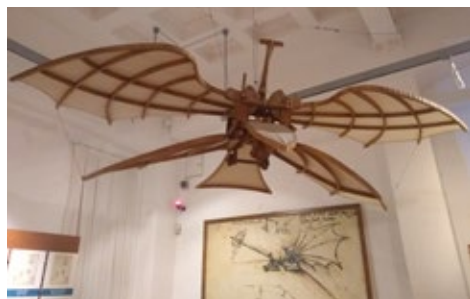
Figura 181 (acima). Planador com asas parcialmente fixas. A parte fixa é destinada ao piloto, e a móvel, com utilização de alças, cordas e discos ativam a parte que dá movimento às asas.
