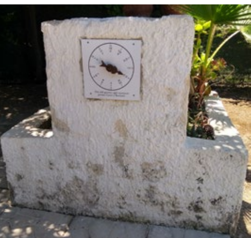
Figuras 108 e 109. O relógio de água (clepsidra) de Arquimedes. O ponteiro de horas, ligado ao eixo à direita de madeira, é movido pelo lento esvaziar, ou encher do tanque.
