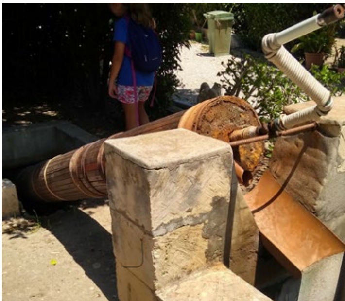
Figuras 110 (acima). A cochlea, sistema de elevação de água usando o princípio do plano inclinado (parafuso). Ao girar a manivela, a água é levada de um reservatório inferior, para um superior.
